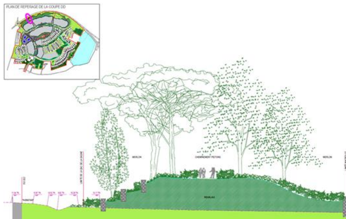
Illustration 48 : Remblai prévu au nord de la ZAC et jouant le rôle de merlon antibruit vis-à-vis de la RD 332
